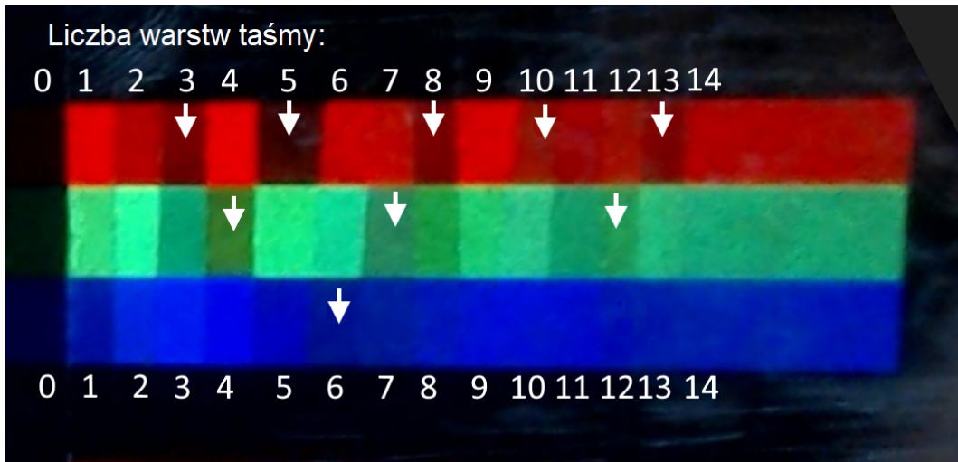
Rysunek 3: Zdjęcie kolorowych obszarów na ekranie widocznych przez różne liczby warstw taśmy klejącej. Strzałkami zaznaczono odczytane minima intensywności przechodzącego światła, w których opóźnienie pomiędzy składowymi światła o różnych polaryzacjach jest wielokrotnością długości fali.
